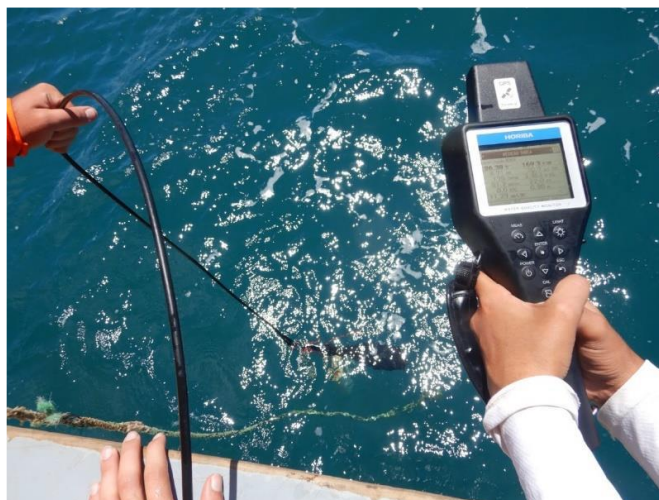
Figura 3: Coleta de dados em campo para mensuração das variáveis ambientais utilizando sonda multiparâmetro
