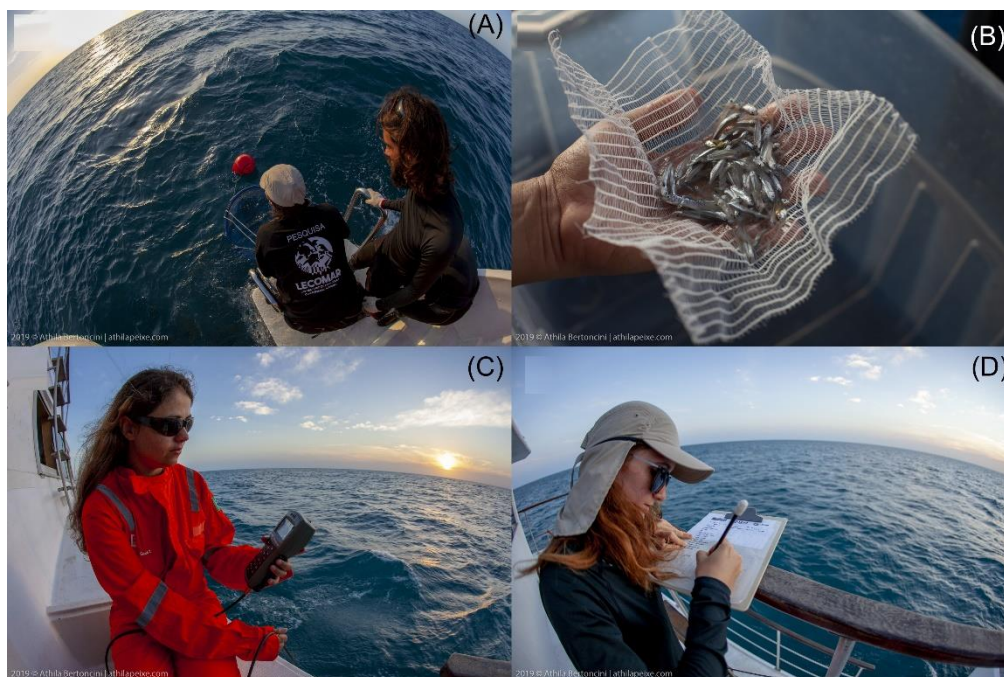
Figura 7: Registro fotográfico das amostragens. A) Armadilha luminosa sendo recolhida após 12 h de imersão. B) Representação das amostras coletadas. C e D) Mensuração e registro dos dados físico-químicos e meteoceanográficos
